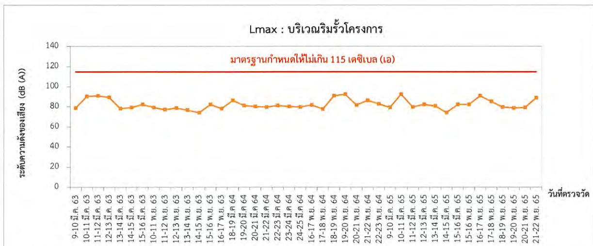
รูปที่ 3.4-15 เปรียบเทียบผลการตรวจวัดระดับเสียงสูงสุด (Lmax) ระหว่างปี พ.ศ. 2563-2565
